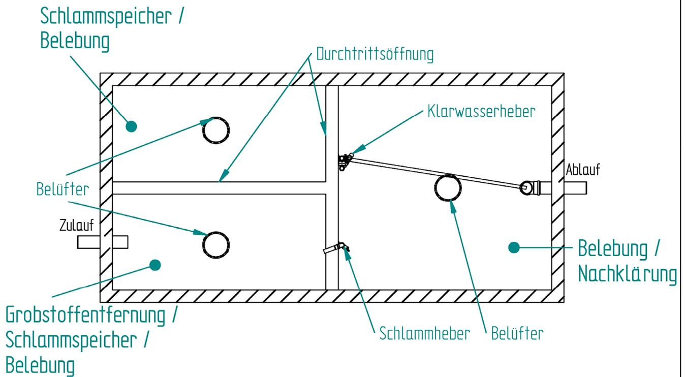
Alle Kammern können auch separate, in unterschiedlicher Form und Größe ausgebildete Behälter sein. Zu- und Abläufe der Nachrüstung sind der entsprechenden Ausführung anzupassen. Einzelne Kammern bzw. Behälter können, falls es sich aus der klärtechnischen Berechnung ergibt, stillgelegt werden. Auch andere Behältermaterialien in anderen Formen und Größen sind unter Einhaltung der Mindestvolumina nutzbar.
