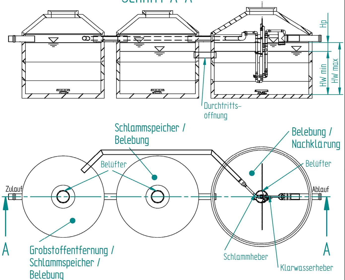
Alle Kammern können auch separate, in unterschiedlicher Form und Größe ausgebildete Behälter sein. Zu- und Abläufe der Nachrüstung sind der entsprechenden Ausführung anzupassen. Einzelne Kammern bzw. Behälter können, falls es sich aus der klärtechnischen Berechnung ergibt, stillgelegt werden. Auch andere Behältermaterialien in anderen Formen und Größen sind unter Einhaltung der Mindestvolumina nutzbar.
