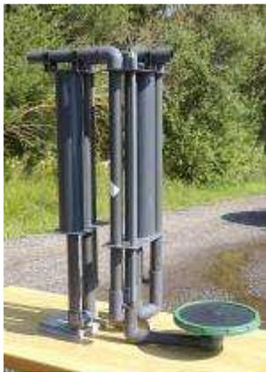
Im Vorbecken wird der Zulaufheber mit entsprechender Aufhängung eingesetzt.
