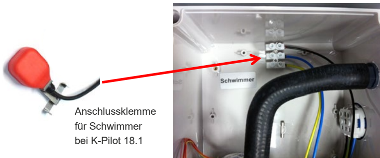
Abbildung 27: Anschluss Schwimmerschalter in K-Pilot 18.1
