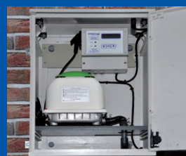
Wandhalterung zur Außen- und Innenaufstellung mit Steuereinheit , netzunabhängiger Stromausfallerkennung (NUSA), energieoptimiertem Verdichter (80l/min) bis zu einer Wassertiefe der Kleinkläranlage von 1,60 m , Maße (H,B,T) 540x400x245 mm.
