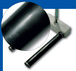
Membranbelüfterkerzen Mit Gewicht gegen Auftrieb. Für die optimale ganzflächige Belüftung des Wirbelschwebbettbeckens.
