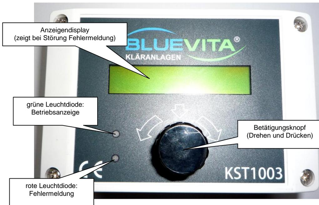
Bild 3: Steuerbox KST1003 (seit Mitte 2010) mit Anzeigen und Bedienknopf
