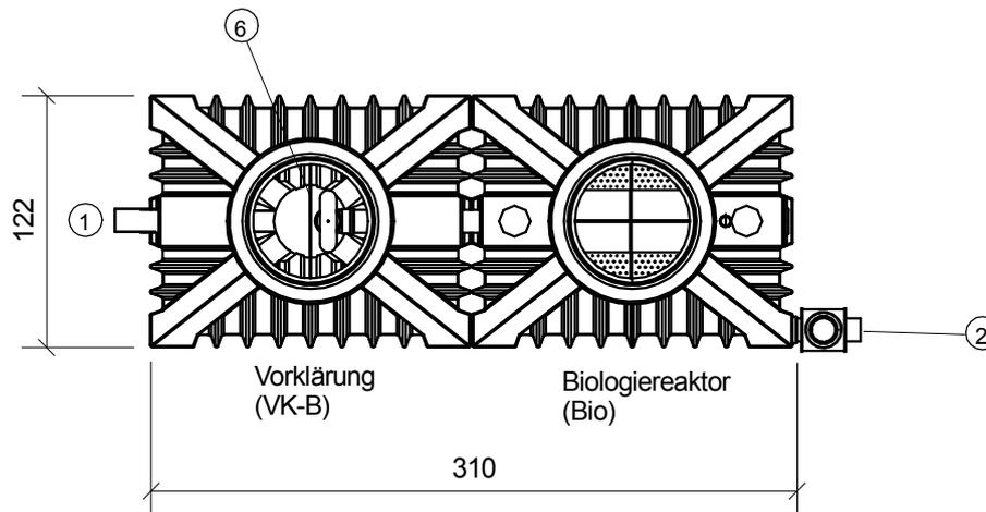
1. Zulauf DN100 ( $\text{\O}a=110\text{mm}$ ) (Mat. KG/PE)
