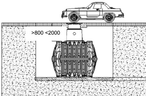
Überdeckungshöhen mit Teleskop Domschacht Guss (Klasse B) im PKW-befahrenen Bereich
