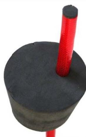
Schlauch durch die dünne oberste Schicht stoßen. Der Stanz-Rest bleibt an den Schlauchenden kleben.
