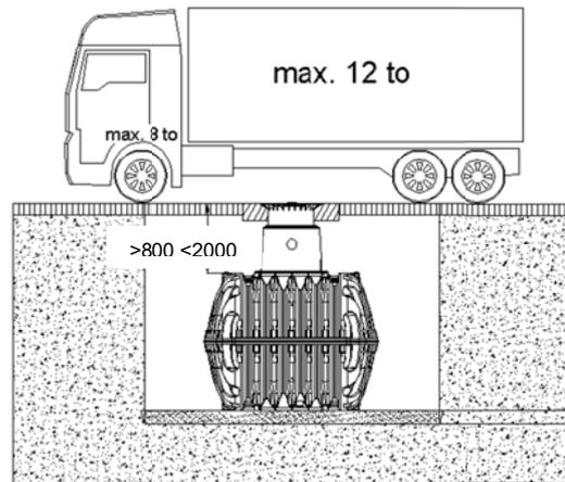
Überdeckungshöhen mit Teleskop Domschacht Begu (mit Abdeckung Klass D – bauseits zu stellen) im LKW 12 befahrenen Bereich
