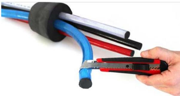
Schlauchende abschneiden, um den Stanz-Rest zu entfernen.
