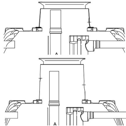
Das Standrohr zur Schlammentnahme ist mit dem mitgelieferten KG-Rohr DN 150 in den Tankdom hinein zu verlängern. Je nach Tankdom und einschubtiefe des Teleskopdomschachtes ist das KG-Rohr zu kürzen.
