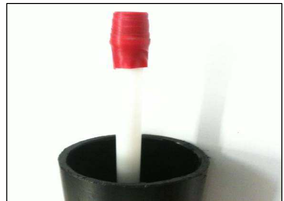
Farbige Markierung oberhalb der Oberkante des Führungsrohres
