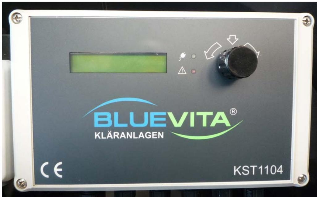
Bild 5: premium-Steuerbox KST1104 mit zweizeiligem Display zur Anzeige des Anlagenzustands, Bedienknopf zum Drehen (beidseitig) und Drücken, Funktionsstatusanzeige durch Leuchtdioden:
