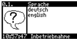
Wählen Sie mit den *OK* und  $\uparrow\downarrow$ -Tasten die gewünschte Sprache für die Menüführung und Displayanzeige und bestätigen Sie mit *OK*. Zur Verfügung stehen deutsch und englisch.
