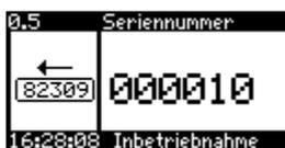
Geben Sie mit *OK* und  $\uparrow\downarrow$  die Seriennummer ein, die sich auf dem *AQUAPRIMO K eco* befindet (nicht die der Steuerung!) und bestätigen Sie jede Ziffer mit *OK*.
