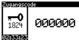
Durch die Eingabe eines Zugangscode ist sichergestellt, daß die Inbetriebnahme von einem Fachmann ausgeführt wird. Geben Sie die 6-stellige Code-Nummer mit *OK* und  $\uparrow\downarrow$  ein und bestätigen Sie mit *OK*.
