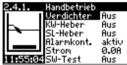
Hier haben Sie die Möglichkeit den Verdichter, die Mammutheber, den potentialfreien Kontakt und den Schwimmerschalter im Handbetrieb zu testen. Es werden der aktuelle Stand des Schwimmerschalters und die aktuelle Stromaufnahme angezeigt.
