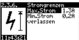
Die Stromgrenzen legen den Bereich der „normalen“ Stromaufnahme des Verdichters fest. Werden Stromaufnahmen gemessen, die unter bzw. oberhalb der festgelegten Werte liegen, wird eine entsprechende Alarmmeldung ausgegeben.
