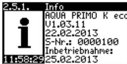
Angezeigt werden die gewählte EW-Zahl, die Software-Version (hier Testversion), Softwaredatum, Uhrzeit und Seriennummer des AQUAPRIMO K eco.
