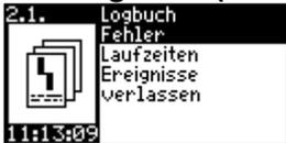
Im Logbuch werden alle relevanten Fehler, Laufzeiten, Ereignisse und hinterlegt.
