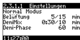
Änderung der Belüftungsintervalle im Sparbetrieb (Betrieb/Pause), Beginn des Sparbetriebes und Dauer der Rückführung (Nährstoffzufuhr aus der Vorklärung durch Rückführung von Abwasser aus der Belebung in die Vorklärung mittels Schlammheber).
