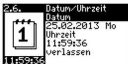
Einstellmöglichkeit für Datum (Anzeige = TT.MM.JJ) und Uhrzeit (Anzeige = HH:MM:SS)
