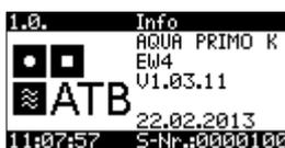
Es folgt der Wechsel zur Infoanzeige. Angezeigt werden die gewählte EW-Zahl, die Software-Version, Uhrzeit und Seriennummer des *AQUAPRIMO K eco*.
