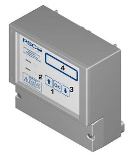
Nach dem Anlegen der Betriebsspannung führt die Steuerung zunächst einen Selbsttest durch. Wird der Test erfolgreich durchlaufen, startet die Steuerung das Hauptprogramm und zeigt zwei im Abstand von ca. 5 s aufeinander folgende Grundfenster in der LCD-Anzeige an.
