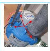
**4:** 4 Schrauben am Drehventil lösen und Schläuche entfernen
