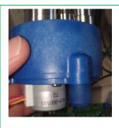
**9:** Drehventil zusammenschrauben (WICHTIG: Die Schrauben nicht zu fest anziehen - BRUCHGEFAHR)
