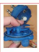
**7:** Neue Kulissenscheibe mit Dichtung aufstecken
