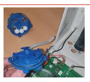
**5:** Drehventil öffnen (auf Kugeln aufpassen); Kulissenscheibe abziehen
