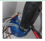
**10:** Drehventil in Steuerung einsetzen und Schläuche montieren
