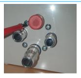
2: Drehventil lösen (4 Schrauben)
